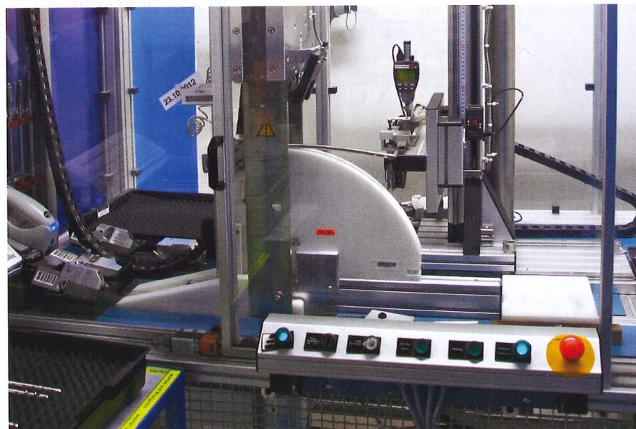
Die Titan- und Edelstahlnägel müssen in einem Zug gebogen werden. Der Biegeprozess erfordert daher eine kontinuierliche Zufuhr hoher Druckluftmengen.
