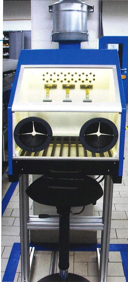
**Ganzheitlicher Ansatz: Nach Gebrauch geht die Druckluft, gesäubert und schadstoffarm, über Lüftungssysteme zurück in die Atmosphäre. Die Abluft wird über Abblas-Schränke, Aerosol-Abscheider und Filter erfasst und aufbereitet.**
