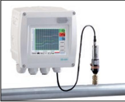
Das Taupunktset DS 400 besteht aus dem Bildschirmschreiber DS 400 und dem Taupunktsensor FA 510 inkl. Messkammer für die Drucktaupunkt-messung von Druckluft und Gasen bis 16/50/350 bar.
