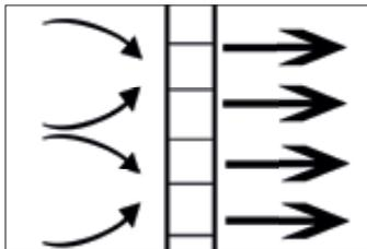
Integrierter Strömungsgleichrichter - keine Einlaufstrecken notwendig
