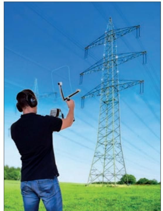
Überprüfen von Hochspannungs-Freileitungen auf Koronaentladung
