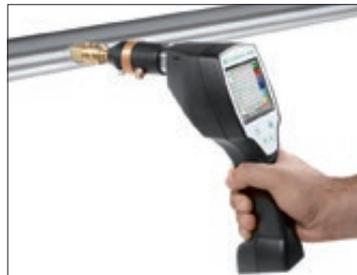
Schneller Einbau mit Messkammer und Schnellkupplung
