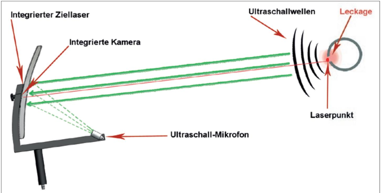
Durch die Bündelung der Ultraschallwellen im Parabolspiegel können selbst kleinste Leckagen von 0,8 l/min (ca. 8 € p. a.) in einer Entfernung bis 10...15 m punktgenau ( $\pm 15$  cm) lokalisiert werden. Die Form des Parabolspiegels gewährleistet, dass nur Ultraschallwellen der angepeilten Leckage ausgewertet werden. Störgeräusche werden auf ein Minimum reduziert.
