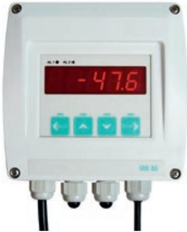
Mit der LED-Prozess-Anzeige DS 52 im formschönen Wandgehäuse entfällt das lästige Suchen und der Einbau in ein passendes Kunststoffgehäuse. Das DS 52 verfügt über 2 potenzialfreie Alarmkontakte (Wechsler), die max. mit 230 VAC, 3 A belastet werden können. Die Alarmgrenzen sind per Tasten frei einstellbar.
