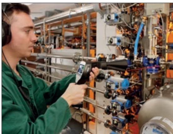
Der schalldichte Kopfhörer ermöglicht die Lecksuche auch bei extrem lauter Umgebung. Die Umgebungsgeräusche werden ausgeblendet, die Leckage (nicht hörbarer Ultraschall) wird in ein hörbares Signal gewandelt. Der Laser ermöglicht eine genaue Ortung.
