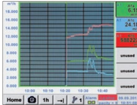
So kann sich der Anwender die gespeicherten Messkurven auch ohne PC zu jeder Zeit vor Ort anschauen. Dies ermöglicht eine schnelle und einfache Analyse des Druckluft oder Gasverbrauches.
