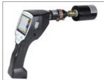
Trockenbehälter sorgt für Senserschutz und eine schnelle Angleichzeit
