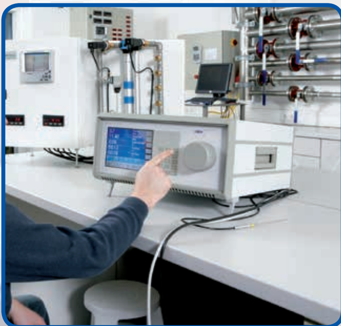
Kalibrierbereich: von -80 bis 20^{\circ}\text{Ctd} Genauigkeit der DKD-Referenz: 0,1^{\circ}\text{Ctd}
