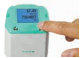
Innendurchmesser über Tasten einstellbar
