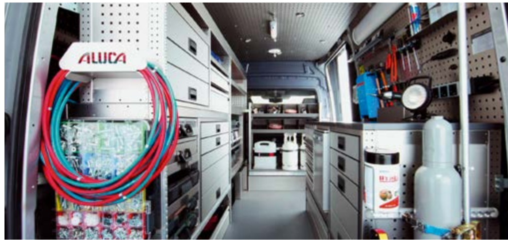
Modernste Fahrzeugeinrichtung aus 100 % Aluminium, die nach den individuellen Wünschen der Kunden angepasst wird.
