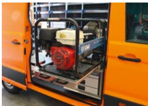
Energieversorgung mit einem Generator auf Schwerlastauszug
