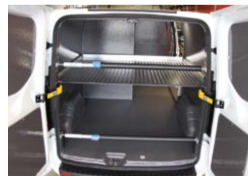
Lebensmittelechte Versiegelung des gesamten Innenbereiches des Laderaums
