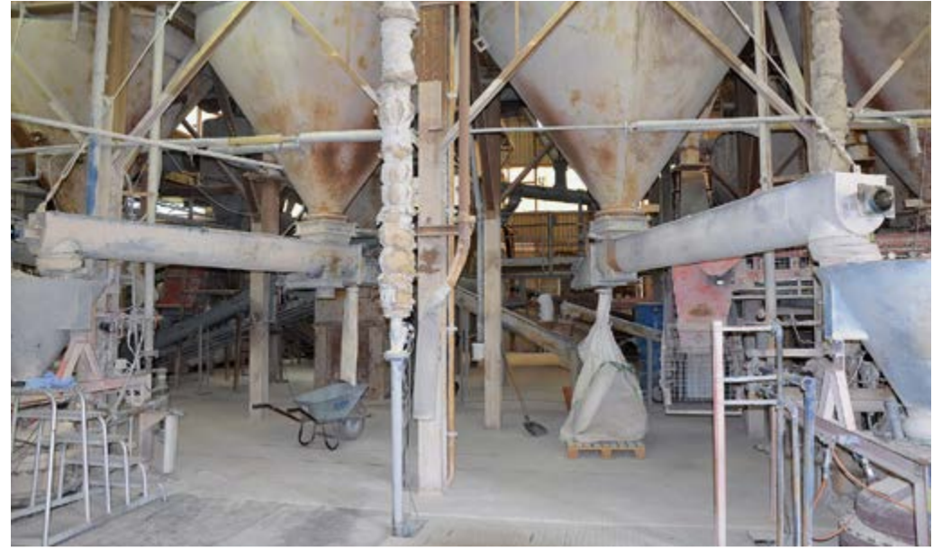
Hier kommt nach der Trocknung der Rohstoff in Silos. „Überall kommt Druckluft zum Einsatz.“
