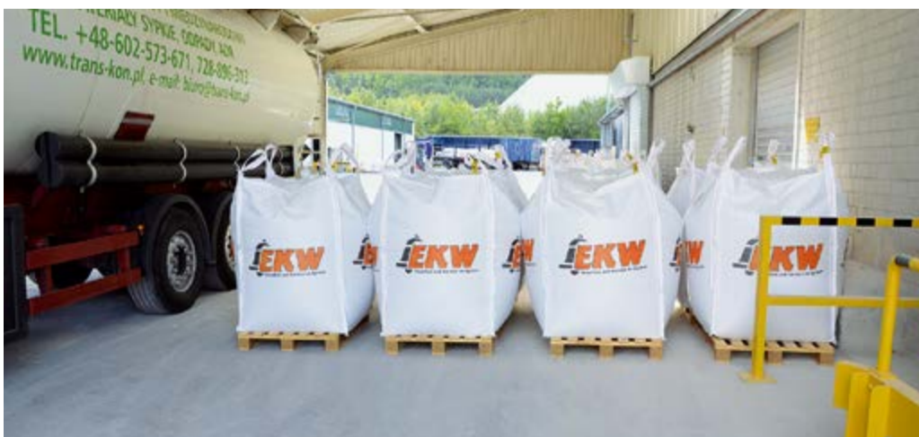
Die fertigen Produkte werden in Bigbags abgefüllt und auf Paletten gestapelt, in Säcke verpackt oder lose in Silo Lkw verladen.
